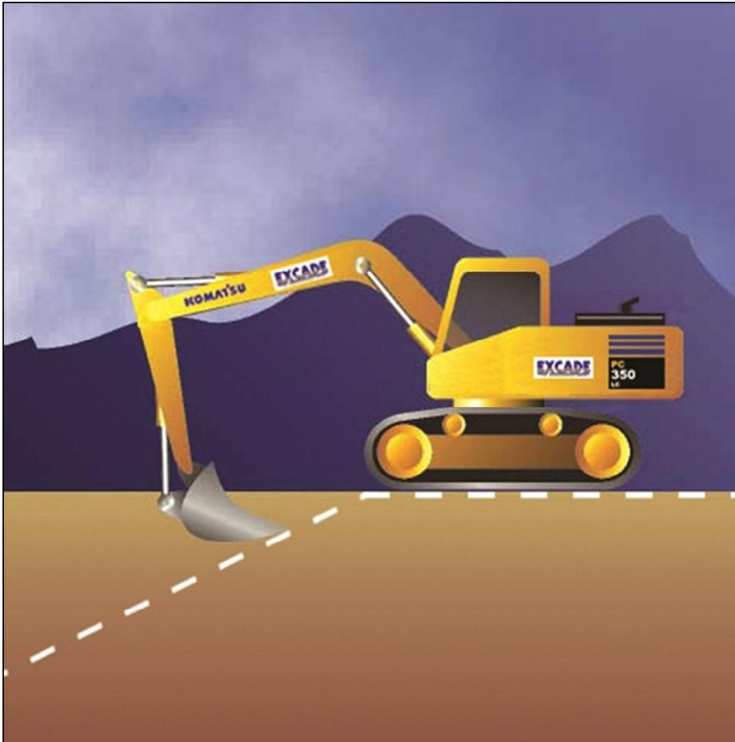
Imagen 35. Ejemplo de desmonte de un talud con retroexcavadora sobre cadenas.
